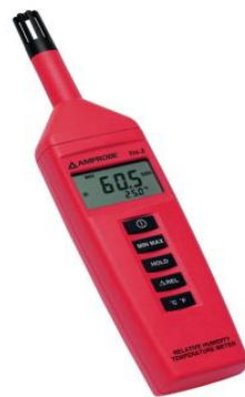
ნახ. 7.23 ფარდობითი ტენიანობის თემოერატურის საზომი Amprobe TH-3
