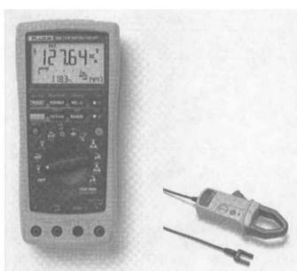
ნახ 7.12 მუდმივი და ცვლადი დენის ციფრული მულტიმეტრიდამხმარე მოწყობილობებით.
